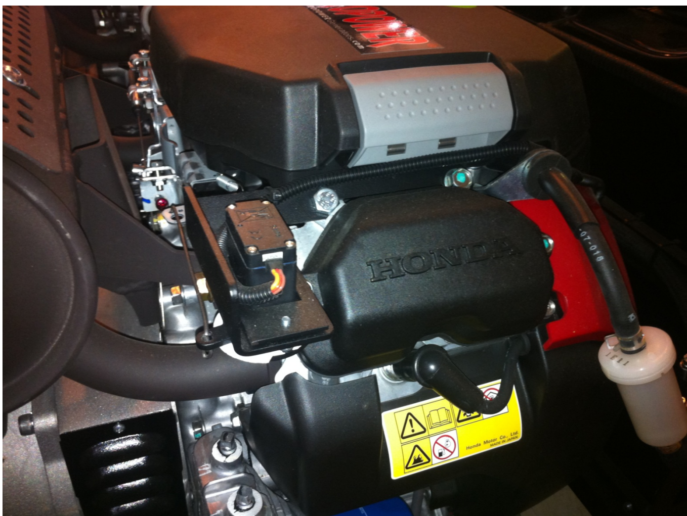
Рис 2 Отсоединить тросик 1 ручного привода от тяги воздушной заслонки и на его место вставить тягу актуатора, после этого закрепить актуатор на корпусе двигателя головки цилиндра двумя болтами, входящими в комплект МС.
