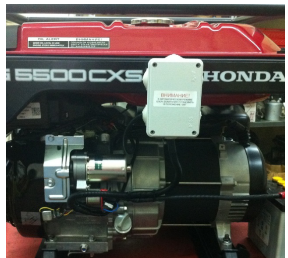
Рисунок 7 Размещение проводов топливного клапана и блока MS
