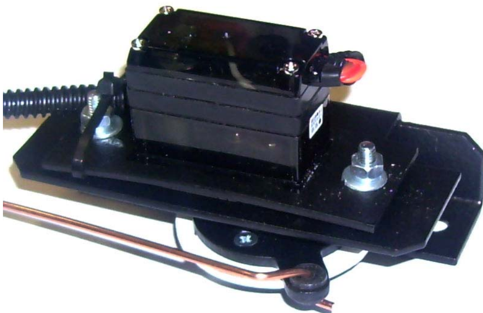
Рисунок 4 – Внешний вид актуатора с тягой управления ВЗ
